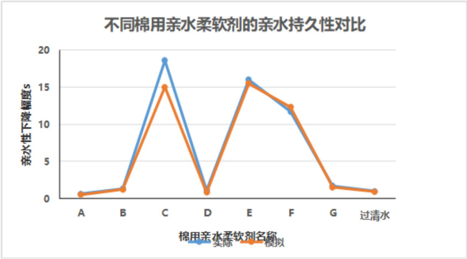
图 1 实际、模拟情况下不同棉用亲水柔软剂的亲水持久性对比图
